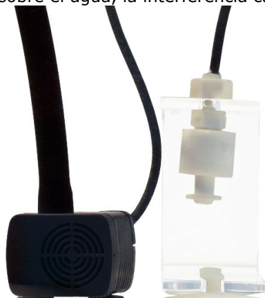
Fig. 3: La bomba de relleno y el protector contra trabajo en seco se fijan en la base del tanque de relleno mediante ventosas.
